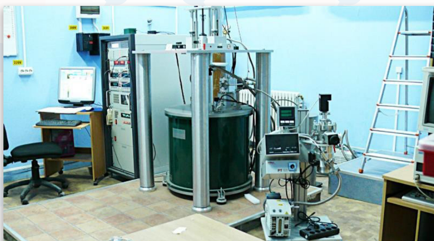
Magnetometru cu probă vibrantă (VSM) (Cryogenics)
