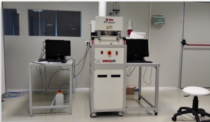
Instalație CVD grafenă
