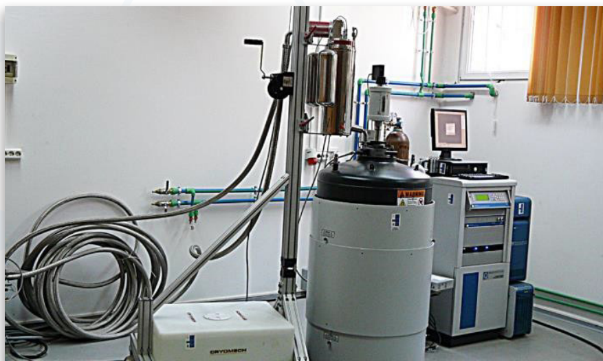
Sistem de măsură a proprietăților fizice (PPMS) (Quantum Design)
