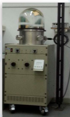
Instalație de depunere filme metalice
