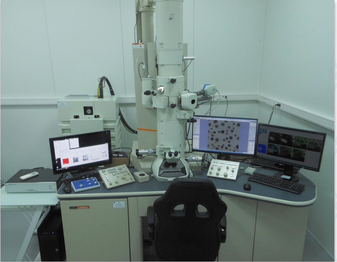
Microscopul electronic analitic de înaltă rezoluție prin transmisie JEM 2100
