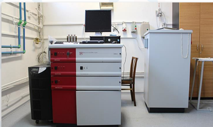
Magnetometru bazat pe detecție SQUID (Superconducting Quantum Interference) (Quantum Design)
