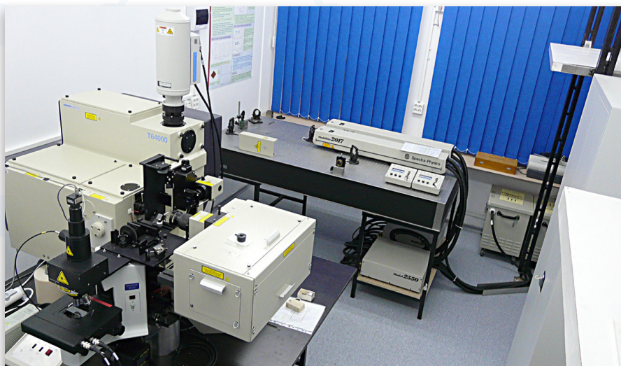
Sistem Raman cu Triplu Monocromator și Microscop Confocal, Model T64000 (Horiba Jobin Yvon)
